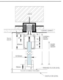
FRAMELESS GLASS CAVITY SLIDER FULL HEIGHT (FLOOR TO CEILING)
